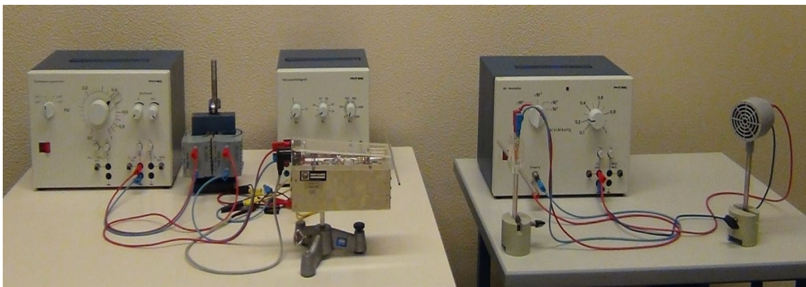
Abb. 2: Versuchsaufbau des ersten Demonstrationsversuchs. Während der Durchführung betrug der Abstand zwischen Sende- und Empfangsantenne zirka 3 Meter.
